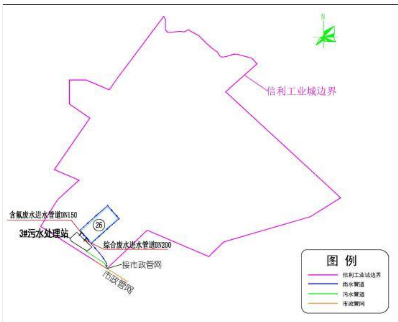
图 3-1 26 号厂房的污水、雨水管网图
